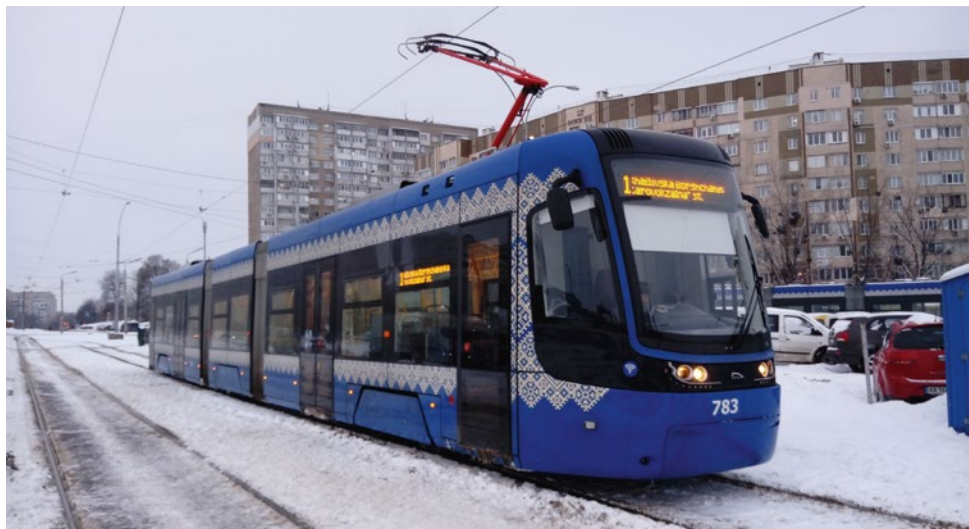
FOT. 4. Wagon polskiej produkcji (PESA) typu 71-414K Fokstrot o numerze taborowym 783 Źródło: fotografia W. Górnikiewicz (2019)
